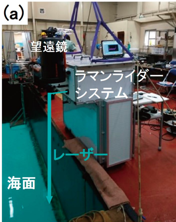
【表紙図】(a)計測バージでの海上ラマンライダーシステム動作試験、(b)システム運搬時の様子
