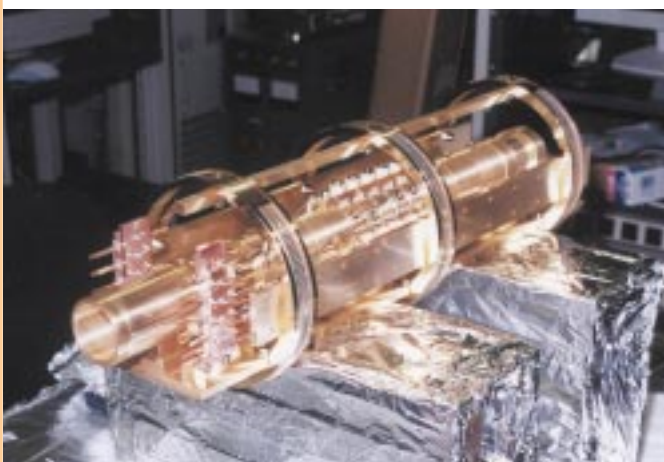
【写真1】東大ASACUSA計画の低速反陽子ビーム発生用冷却トラップ
