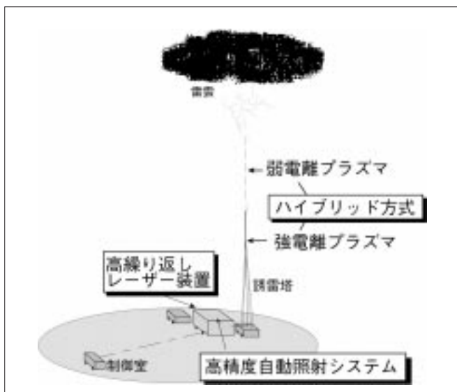
【図1】ハイブリッド方式によるレーザー誘雷概念図
