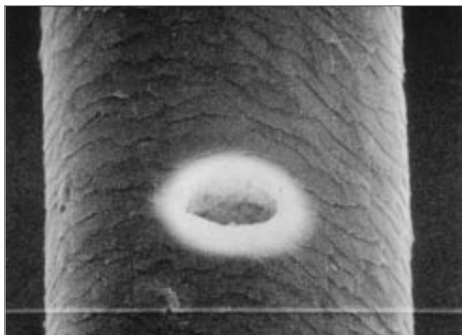
【写真2】髪への長短パルスレーザー照射による穴
