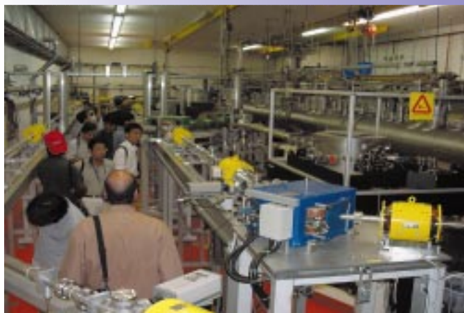
【写真3】装置全体写真。3回周回して加速する。その間にウイグラーに入れ発振を行う。
