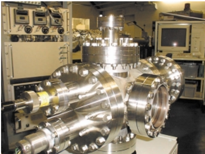
【写真】ダイオキシン類計測を目的とした飛行時間型質量分析装置。右の窓から高い強度フェムト秒レーザーを照射する。試料は上部から導入する。イオン化された分子をMCPで計測、コンピューターに積算する。
