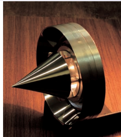
【図】開発中のレーザー推進エンジンの集光部と噴射ノズル(左図)およびベンチテストモデル(右図)
