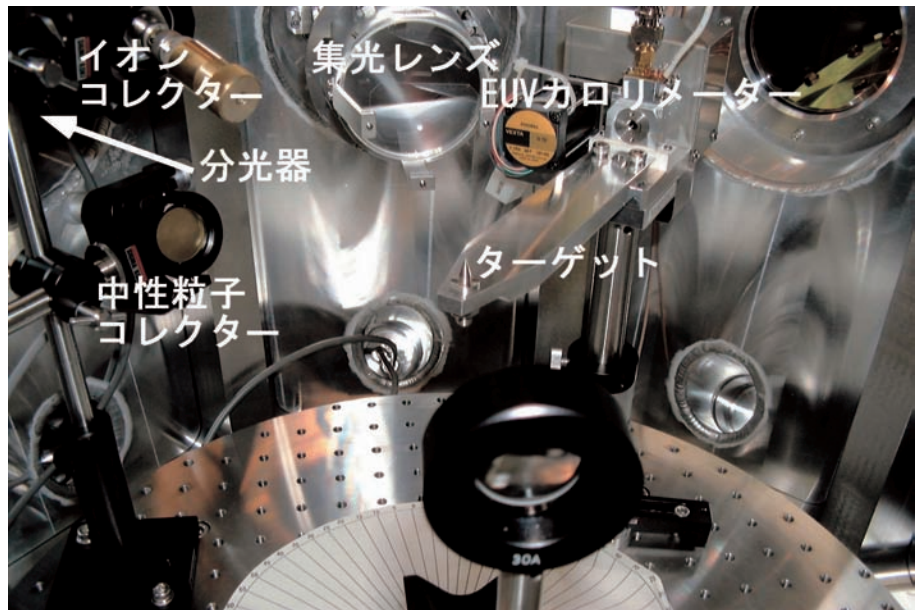
【写真】各種計測器が取り付けられたEUV実験用真空タンクの内部
