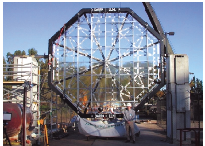
【写真2】米国で開発が進む高効率フレネル回折レンズ
