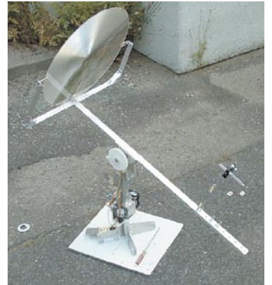
【図1：左】CrおよびNdの励起と量子遷移のメカニズム、Crに吸収されたエネルギーは量子遷移をへてNdの励起準位に移行しNd発振が集中的に起こる 【図2：右】自然太陽光での発振実験装置
