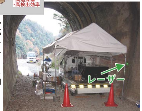
【口絵1(上)】トンネルコンクリートの内部欠陥を探傷するレーザー超音波リモートセンシングシステム 【口絵2(下)】廃トンネルのコンクリート内部欠陥探傷実験
