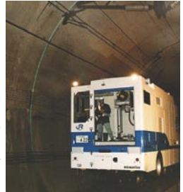
【図2】トンネル履工表面検査システム。緑のレーザーを用いてコンクリートの表面状態を観測する装置
