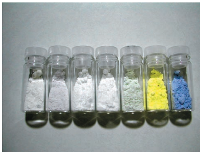
【写真】種々の添加元素を加えたYAG粉体材料
