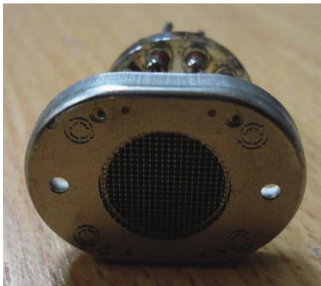
【写真1】カーボンナノチューブ電子源 φ10 mmのグリッド電極に電圧を印加することで容易に高密度電子群の放出が可能
