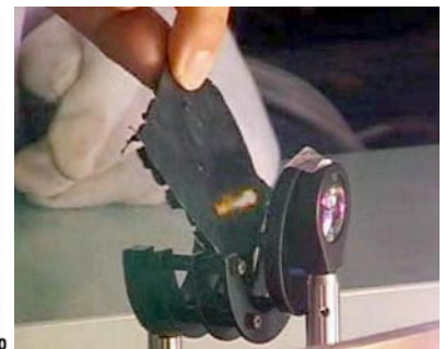
【図3】室内アブレーション実験の様子(10Hz x 100mJ)
