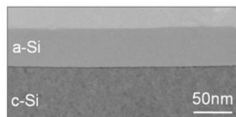
照射波長800 nm (a-Si厚: 42 nm)
