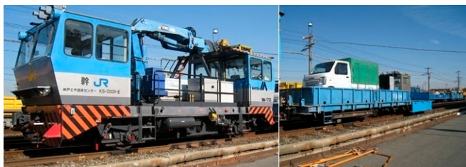
【図1】トロに積載したレーザー装置をディーゼル機関車で牽引してトンネルまで運搬
