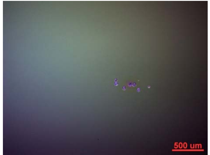
【表紙写真】P偏光照射のレーザー損傷形状(照射エネルギー密度78 J/cm 2 )
