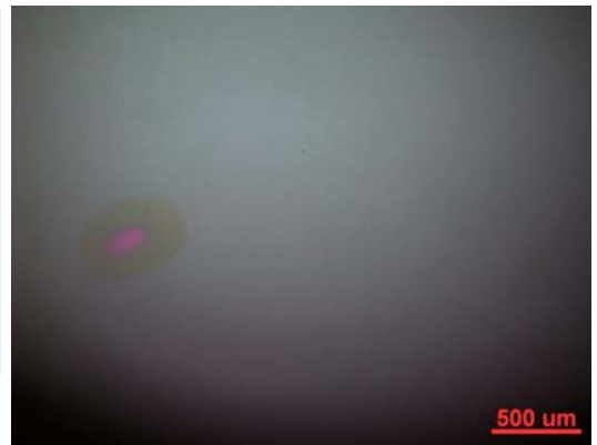
【図2】S偏光照射時のレーザー損傷形状(照射エネルギー密度347 J/cm²)
