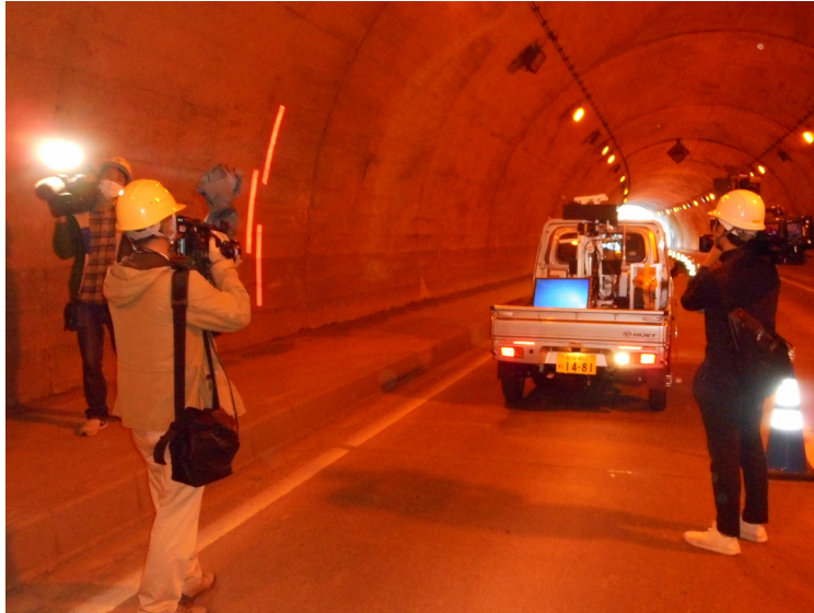
車両走行型高精細レーザー表面計測（レーザー走行計測）の様子
