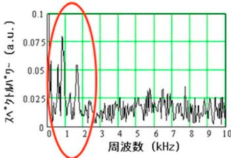
【図3】レーザー装置で計測したコンクリート欠陥の振動スペクトル
