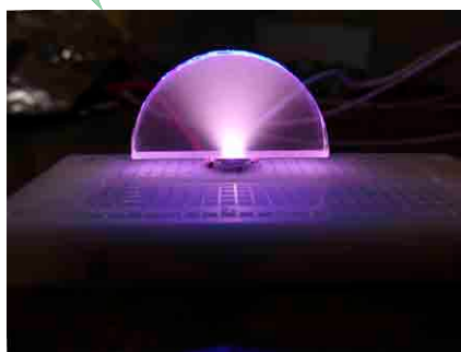
【写真】青色LED照射時のガラス蛍光体の発光の様子
