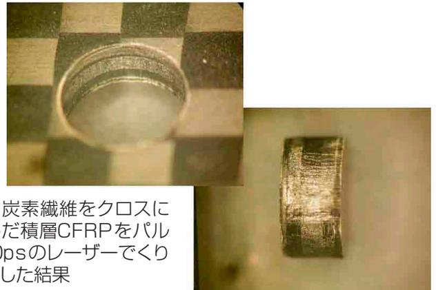
【表紙図】炭素繊維をクロスに織り込んだ積層CFRPをパルス幅200psのレーザーでくり抜き加工した結果
