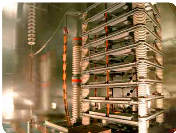
【写真1】750 kV雷インパルスジェネレーター (IG)
