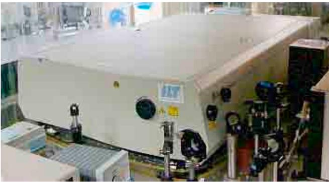
【写真】プラスチック中空球への穴あけ加工に使用している、レーザー総研所有のフェムト秒レーザー
