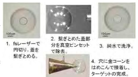
【図5】レーザーガイド用コーン付きプラスチック中空球ターゲットの加工・組み立て方法
