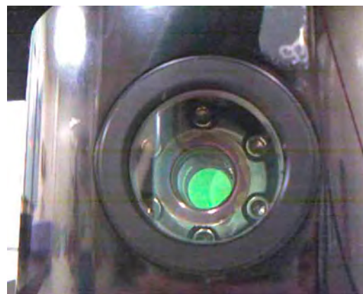
【表紙写真】クライオスタット内に装着されたNd/Cr:YAGセラミックス
