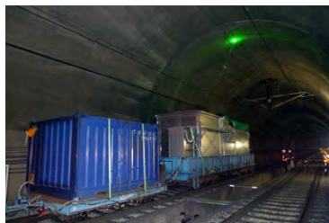
【写真1】計測システム概観 (レーザー計測装置と制御室)
