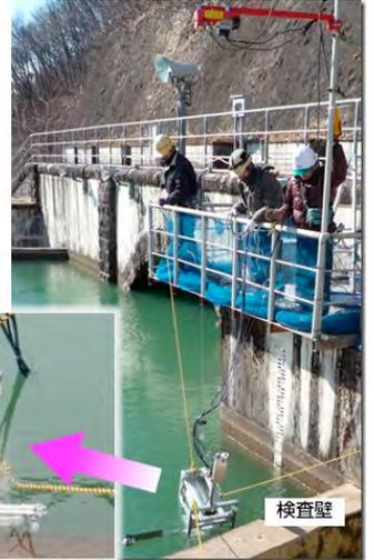
【表紙図】水中コンクリート探傷装置による屋外設備の検査実験時の様子
