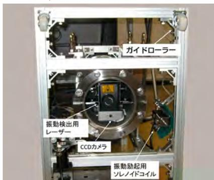
【図1】レーザーを用いた水中コンクリート探傷装置
