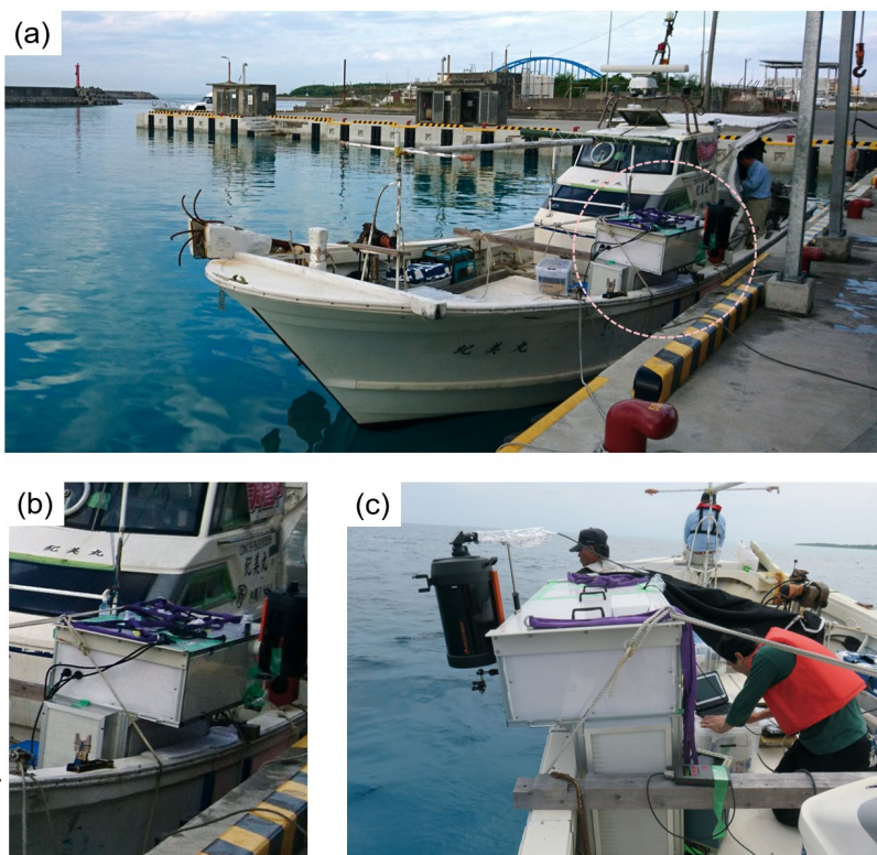
【表紙図】(a) (b) 漁船に搭載した海上ラマンライダーシステム、 (c) 海上観測実験時の様子
