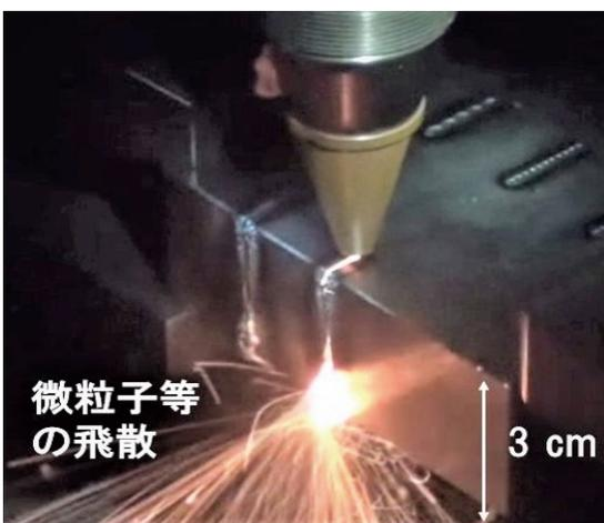
【図2】4 kW連続波ファイバーレーザー(紙面下向き照射)による厚さ3 cmの炭素鋼切断
