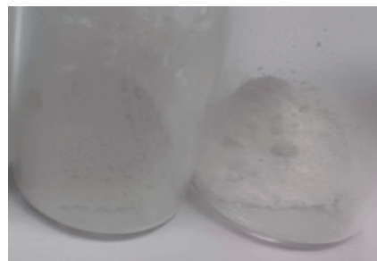
図3 水中での右) レーザー照射前、左) レーザー照射後 (300 mW, 20 min.) の MgO 粉体 (乾燥後)
