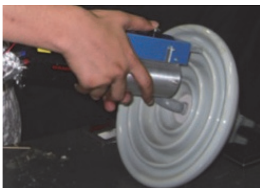
図2 碇子表面の付着塩分計測時の様子
