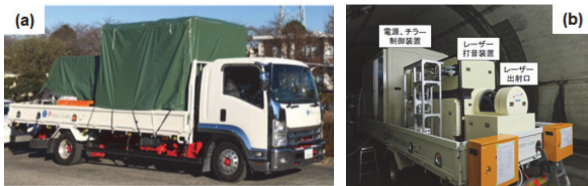
図1. 自走式レーザー打音検査装置
