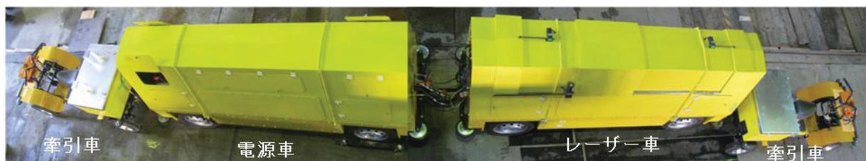
図3 新幹線トンネル内中央通路走行型レーザー検査装置外観
