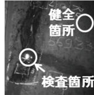
図6 レーザー照射位置
