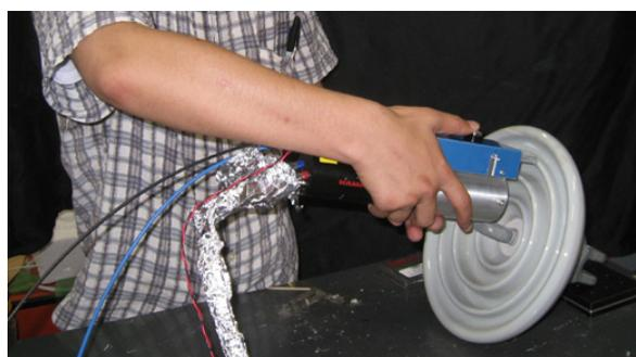
図8 作製した装置による罫子表面塩分計測の様子
