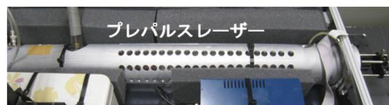
図4 プレパルスレーザー（ $\text{CO}_2$  レーザー）
