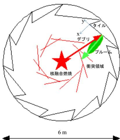
図2 KOYO-fast の液体壁チェンバー第一壁のタイル構造の概念図
