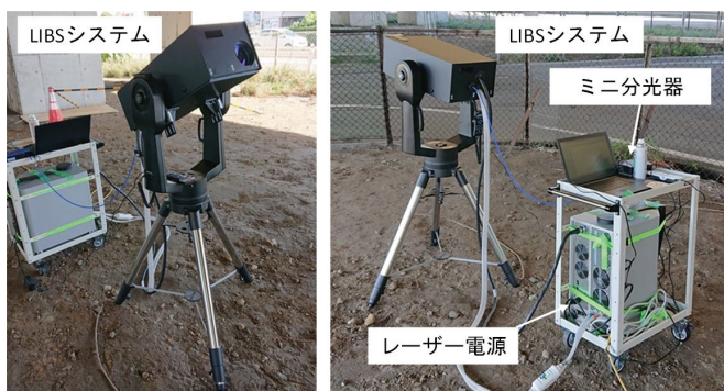
【図1】可搬型リモートLIBSシステム
