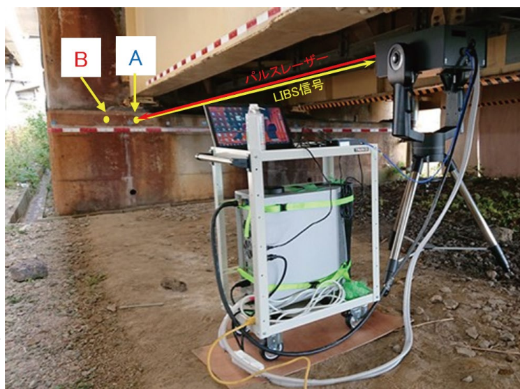
【表紙図】高架橋 でのリモート塩害 評価試験の様子
