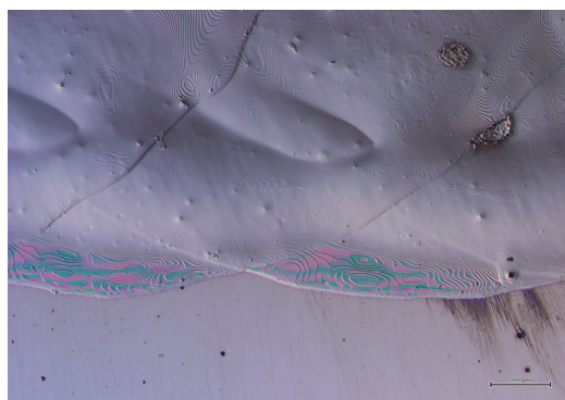
図 6 積層ガラス化したシリコン油
