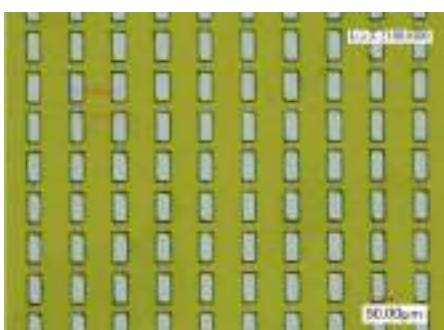
図6 浜松ホトニクス社製ピコ秒レーザー MOIL で厚さ  $25 \mu\text{m}$  のポリイミドフィルムに  $100 \mu\text{m}$  級のスロットを形成(浜ホト社提供)
