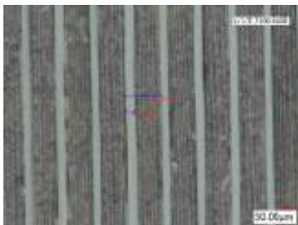
図5 浜松ホトニクス社製ピコ秒レーザー MOIL で厚さ約  $100 \mu\text{m}$  の一方向 Pitch 系 CFRP に幅  $30 \mu\text{m}$ 、ピッチ  $100 \mu\text{m}$  のスリットを形成(浜ホト社提供)
