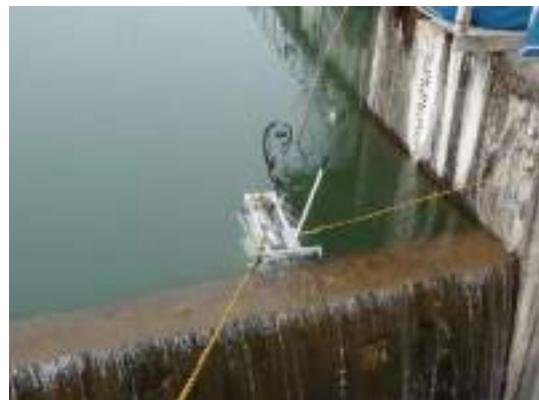
図8 デッキブラシを装着した装置。装置から飛び出した白い棒がブラシの柄。
