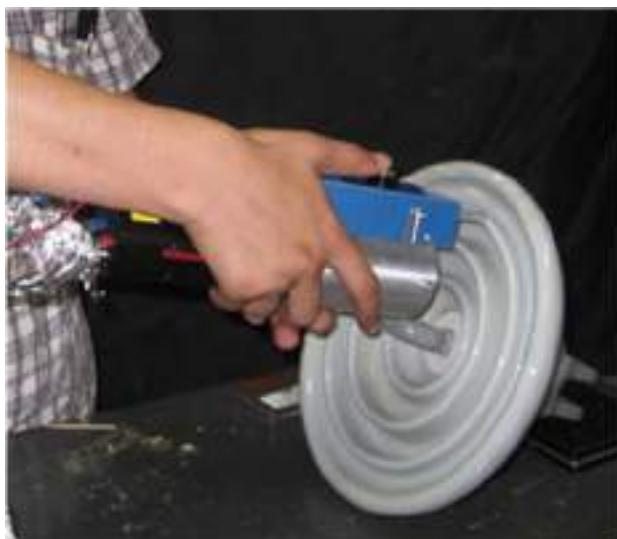
図2 ハンディ型計測装置による碍子付着塩分計測の様子
