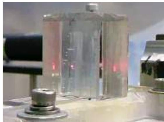
図1 2パルスレーザー損傷試験の様子
