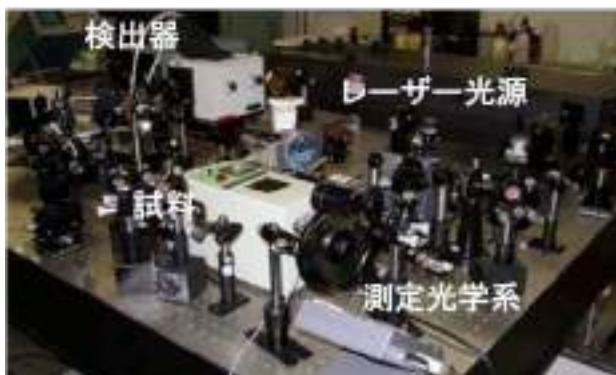
図 3 フェムト秒蛍光計測（アップコンバージョン）システムの写真
