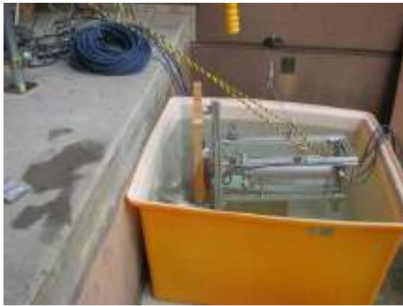
図2 水中レーザー探傷装置動作確認試験の様子
