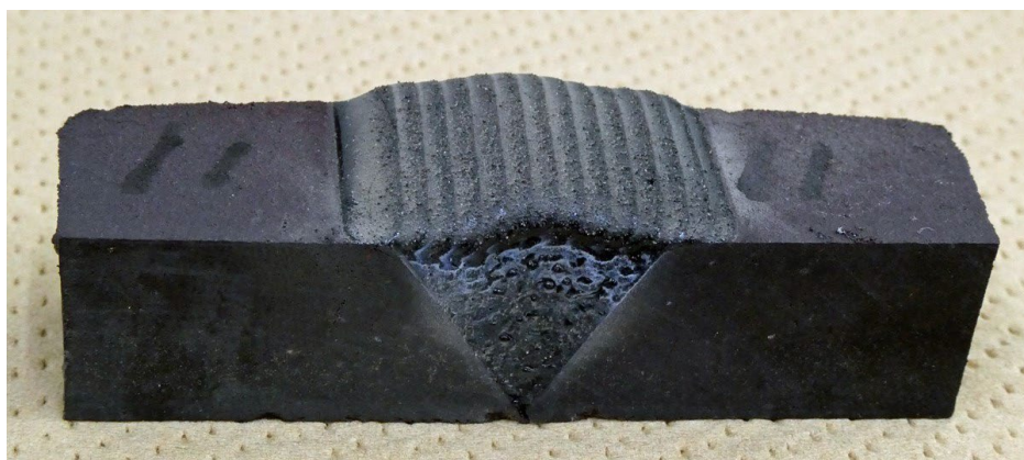
【表紙図】中央のV字型部分 をレーザー積層造形に より接合した供試体
