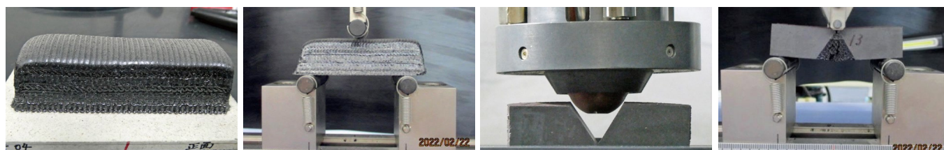
【図1(左から)】曲げ強度試験用供試体の写真 【図2】曲げ強度試験の様子 【図3】治具に固定された接合用供試体とDEDヘッド 【図4】接合部を下向きに設置して行った曲げ強度試験の様子
