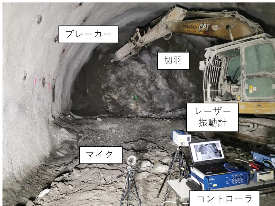
図1. 実際の計測の様子
