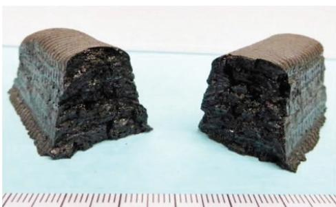
図 4 曲げ強度試験後の供試体
