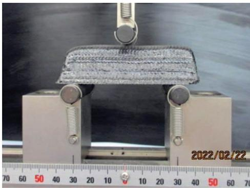
図 3 曲げ強度試験の様子
