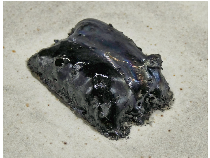
【図5】真空中で造形したサンプル(3ビード × 3層)
