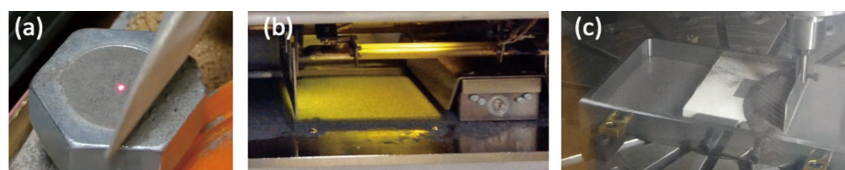
【図2】これまで試してきたパウダーベッド： (a) ボルトとナット、(b) アスペクト社製RaFaEl II、(c) ステンレス製枠
