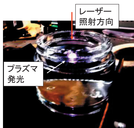
図 2. 食塩水にレーザーを集光照射したときの様子
