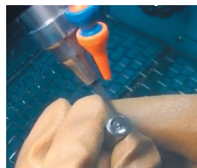
図 15 砥粒を吹き付ける加工装置 AEROLAP® による鏡面研磨の様子。
